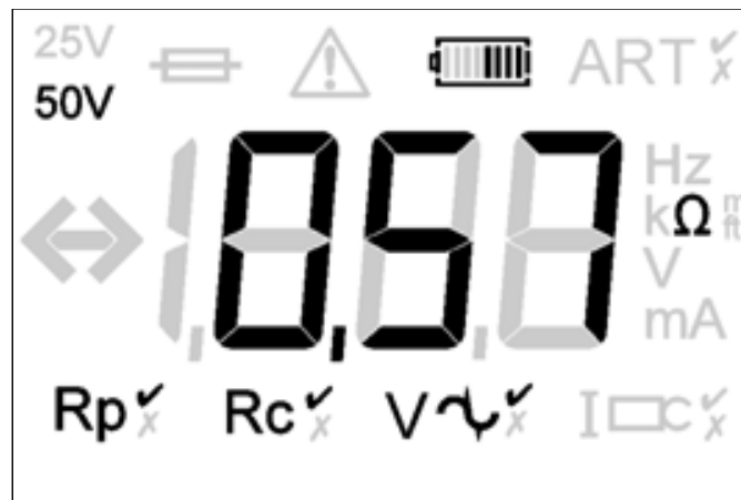
Figura 26: ejemplo de lectura de resistencia de tres terminales con conexión nula (se muestra el visor del DET4)
