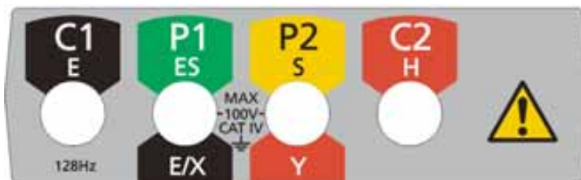
Conexiones de prueba (en la parte posterior del instrumento)
