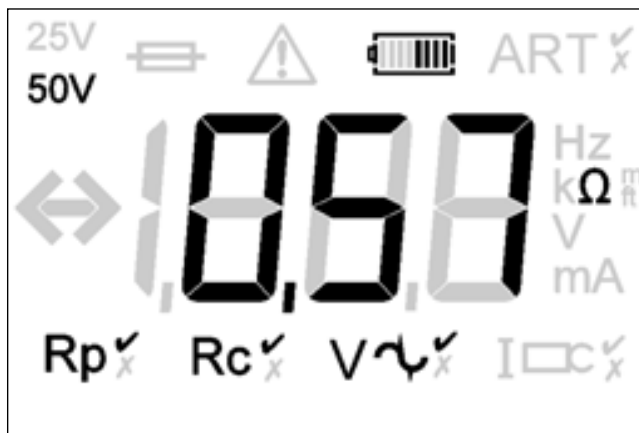
Figura 28: ejemplo de lectura de resistencia de cuatro terminales (se muestra el visor del DET4)
