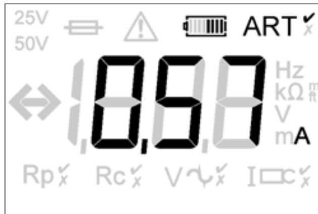
Figura 30: ejemplo de lectura de corriente de retorno por tierra (se muestra el visor del DET4)
