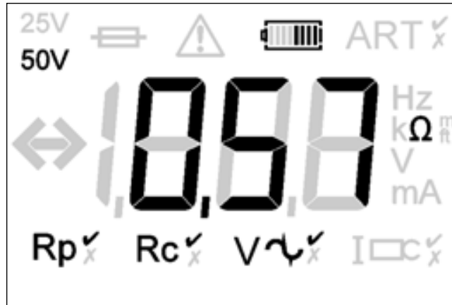
Figura 19: ejemplo de lectura de resistencia de tres terminales (se muestra el visor del DET4)
