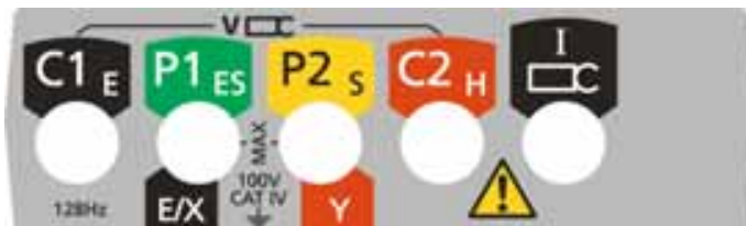
Conexiones de prueba (en la parte posterior del instrumento)
