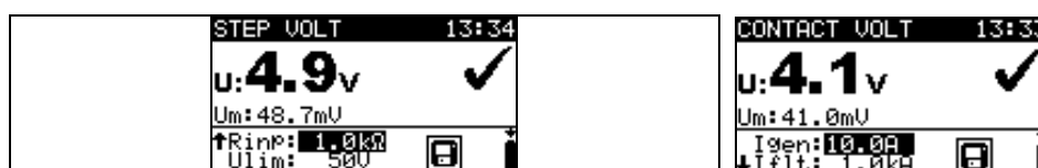
Figura 7.10: Ejemplos de resultados de las mediciones de tensión paso y de contacto
