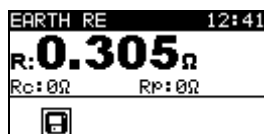
Figura 7.13: Ejemplo de resultado de la medición de resistencia de tierra
